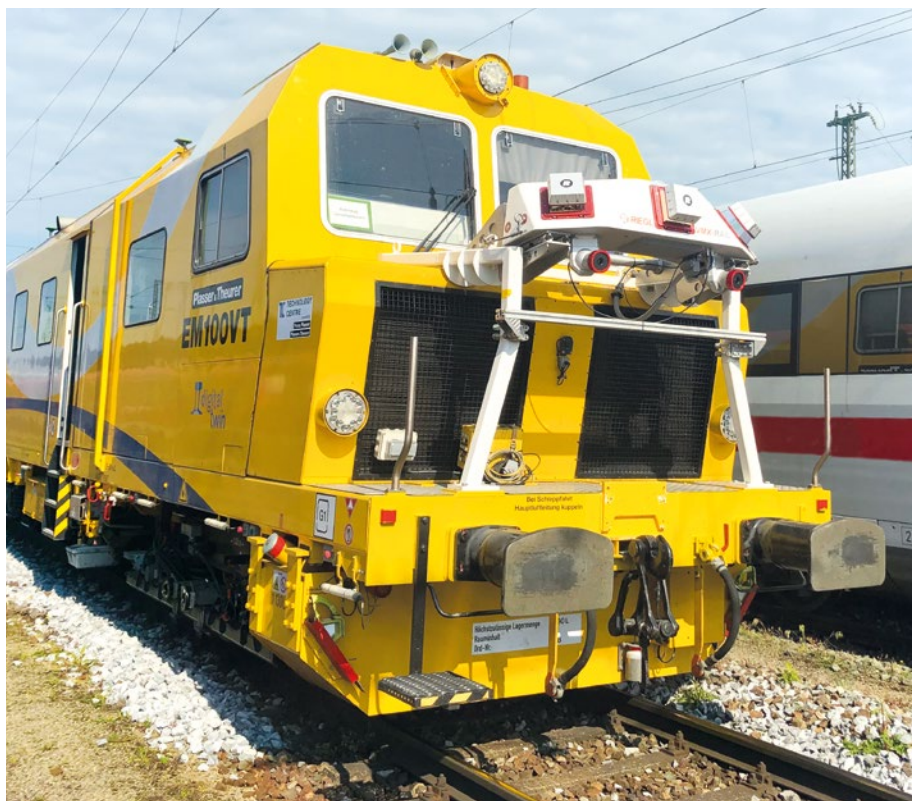
Abb. 5: Riegl VMX-Messsystem auf EM100VT
