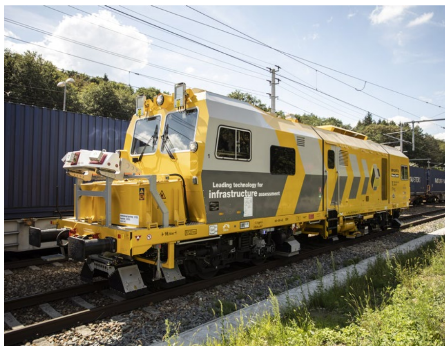
Das von Plasser & Theurer in Kooperation mit Obermeyer entwickelte Multisensor-Fahrzeug EM120VT. Damit wird die Genauigkeit der herkömmlichen Vermessungsmethoden erreicht und gleichzeitig eine sehr viel höhere Menge an Punkten aufgemessen
